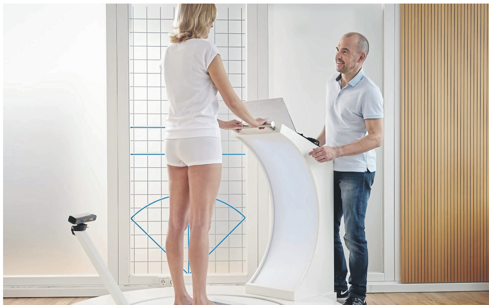
Bodytronic-Messgerät: Der Scanner misst berührungsfrei und exakt das betreffende Körperteil. Das errechnete 3D-Modell bildet die Basis für ein individuelles Hilfsmittel im Bereich der rundgestrickten Kompressionsstrumpfversorgung. FOTO: OT SCHNEIDER
